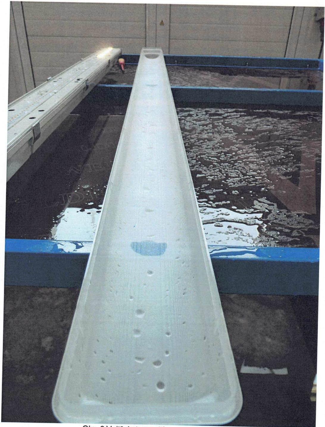
Obr. 6 Vnitřní strana difuzoru po zkouškách
