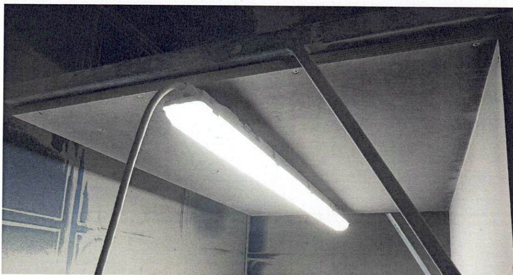
Obr. 1 Vzorek v prašné komoře po zkoušce na IP 6X při funkční zkoušce
