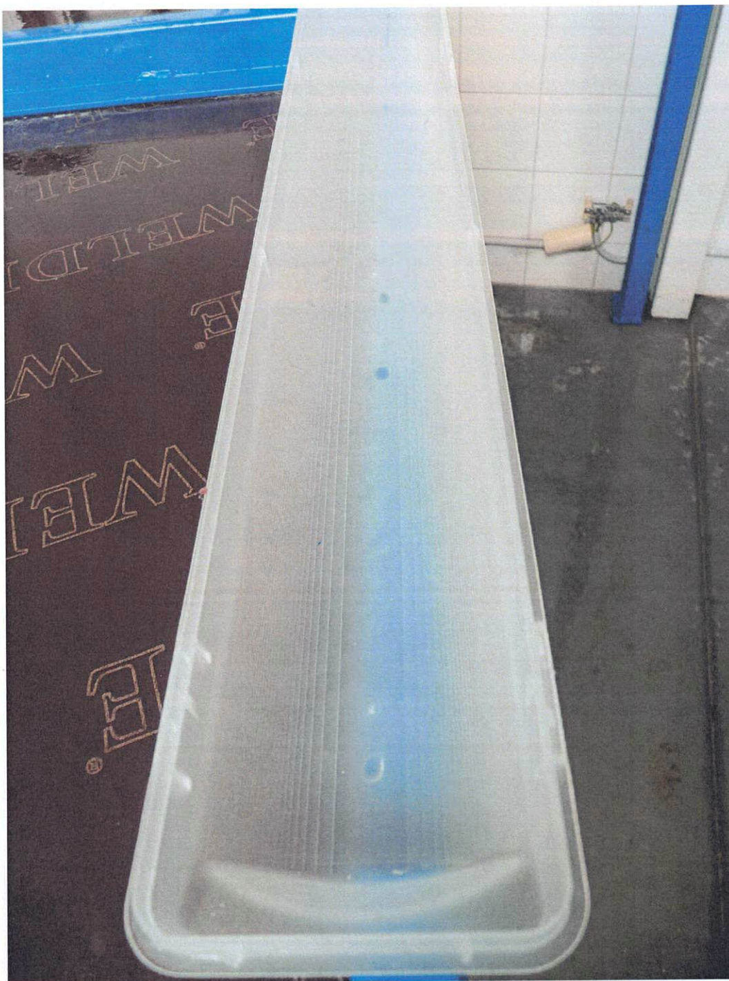
Obr. 19 Vnitřní strana difuzoru po zkouškách
